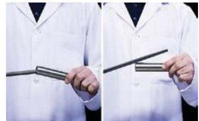
Rebarbe o Tubo interna e externamente
