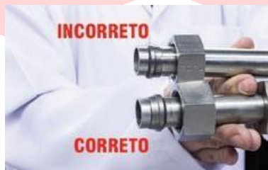
Verifique que o maior diâmetro do anel esteja voltado pra porca
