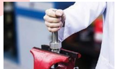
Encaixe a extremidade do tubo no fundo do assento cônico do dispositivo de cravação
