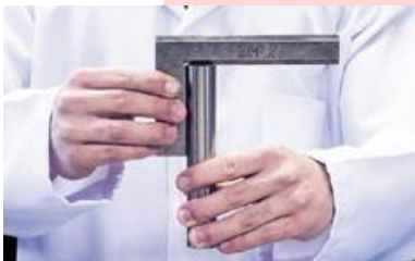
Corte o tubo em esquadro
